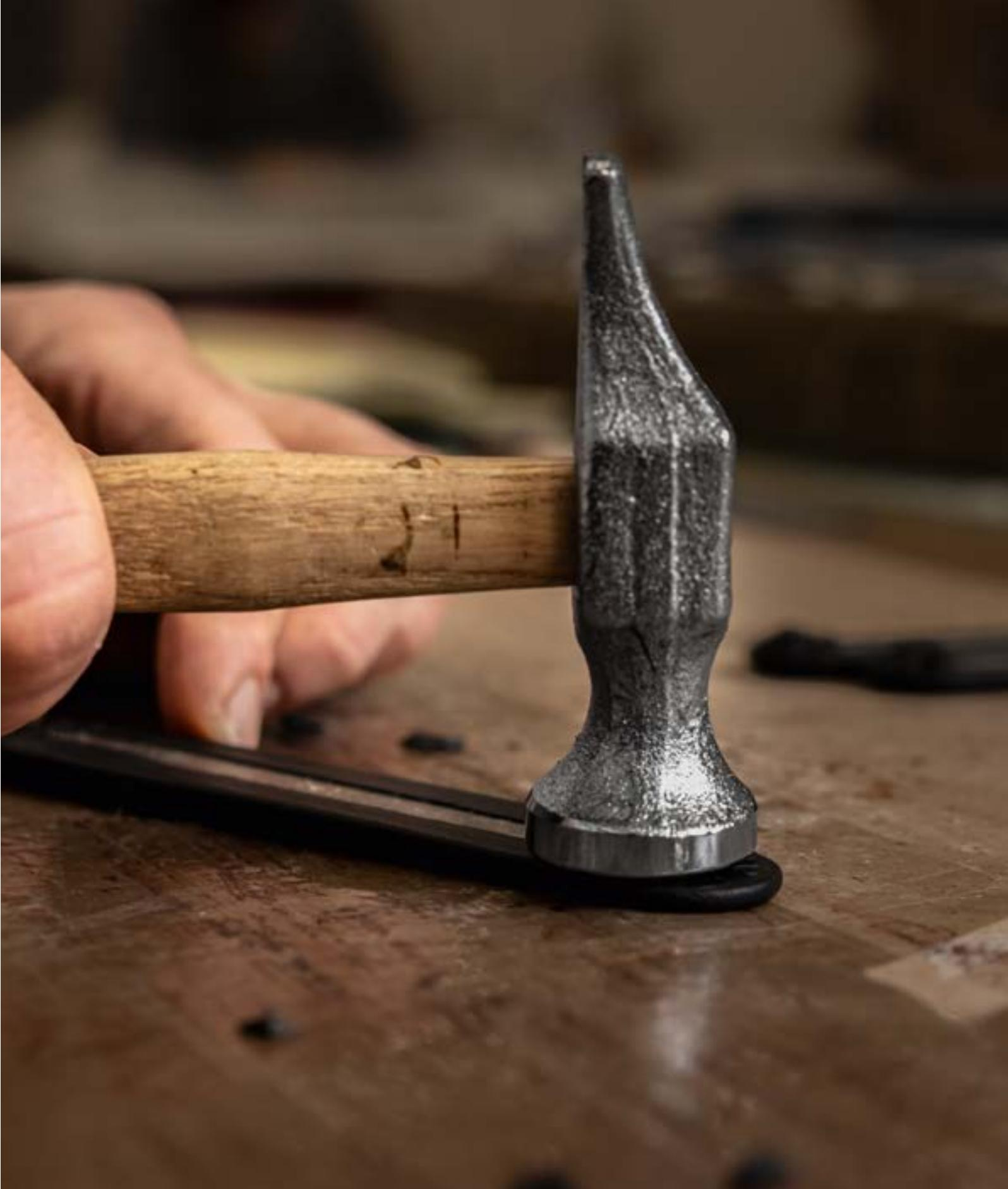
Con questo martelletto, un operaio specializzato elimina ogni piega dell'inserto in pelle, per ottenere il migliore incollaggio e continuità estetica lungo tutto il bordo.
