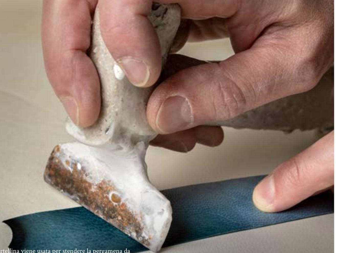
La martellina viene usata per stendere la pergamena da incollare. La complessa ergonomia del manico testimonia l'importanza della manualità necessaria nella lavorazione e nella posa delle pelli.
